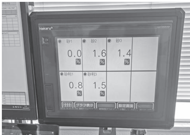
砂と砂利の表面水率を同時に表示可能な「H-TPM」
