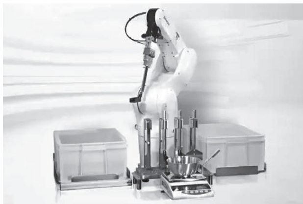
省力化を促進する粉体計量ロボットシステムの開発にも着手している
