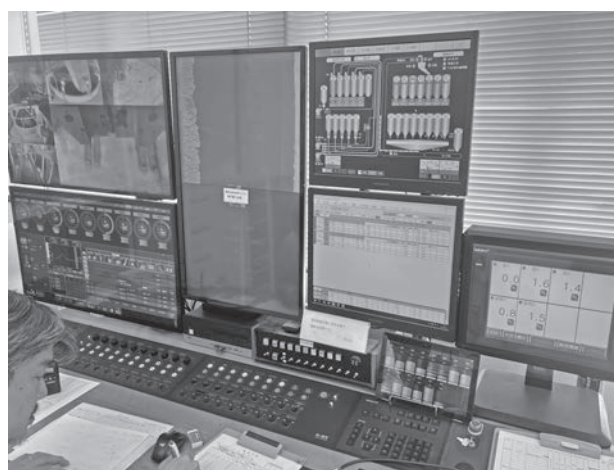
計量操作盤「H-WX」と複数の管理システムを導入・併用している工場もある
