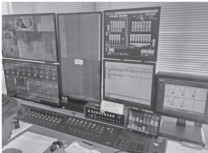
計量操作盤「H-WX」と複数の管理システムを導入・併用している工場もある
