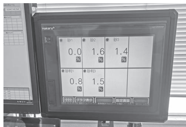
砂と砂利の表面水率を同時に表示可能な「H-TPM」
